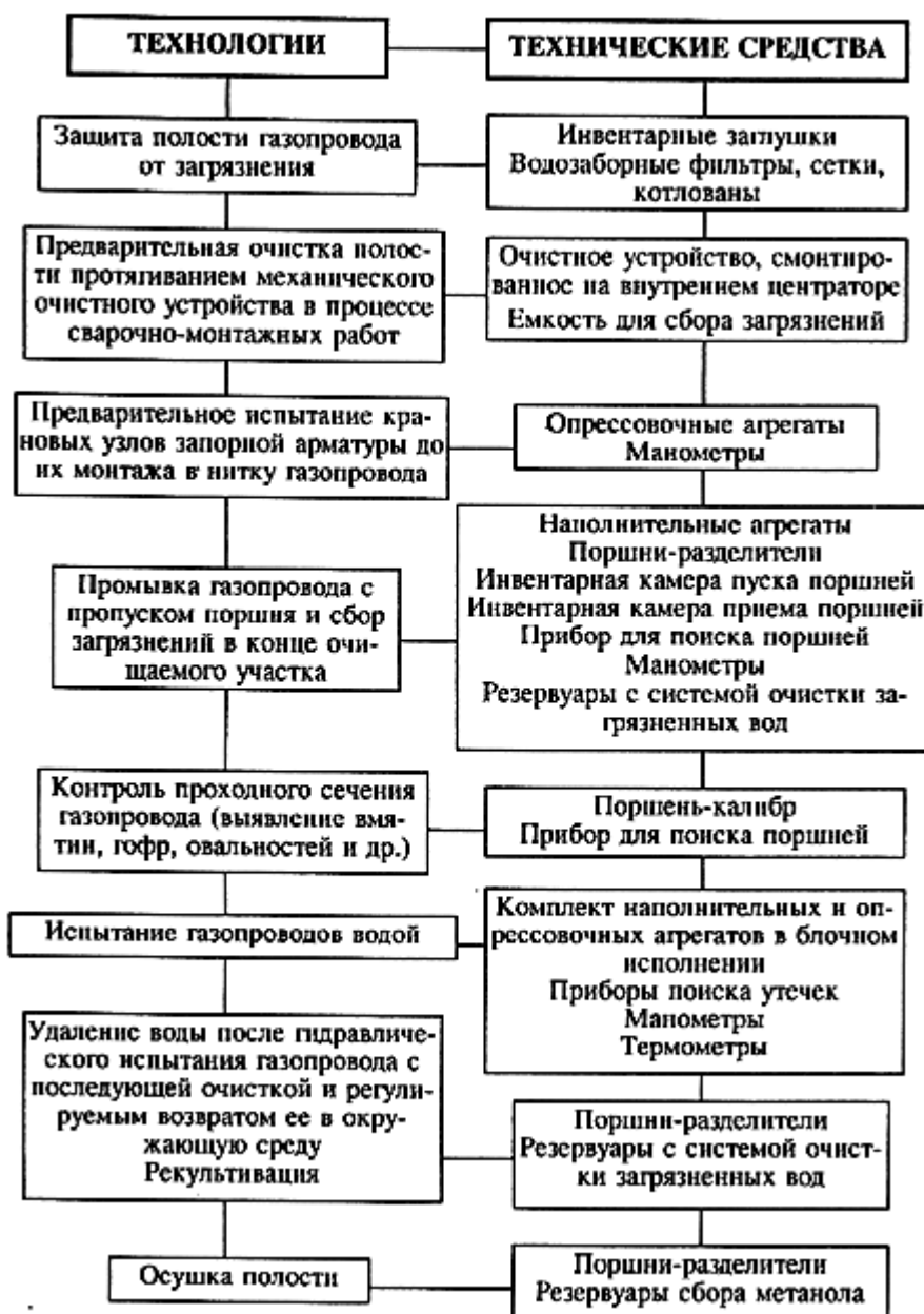
Рис. 2. Технологии и технические средства по очистке полости и испытанию газопроводов гидравлическим способом
